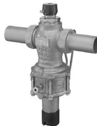
Рис. 1. · Регулятор расхода и перепада давления или регулятор давления Тип 47-1, DN 15 до 32, исполнение с ручным задатчиком для установки заданных значений \Delta p и с наружной крышкой со шкалой для установки заданного значения расхода, клапан с патрубками под приварку.
