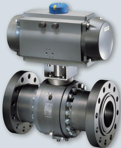
**SAMSON VETEC** – сегментные клапаны VETEC Maxifluss сочетают в себе преимущества прямоходных клапанов, дисковых затворов и шаровых кранов. Универсальность конструкции позволяет использовать краны как в стандартных, так и в критических условиях. Благодаря двойному эксцентрику, поворотный затвор касается седла только при полном закрытии, что обеспечивает точный контроль положения и высокое соотношение регулирования.
